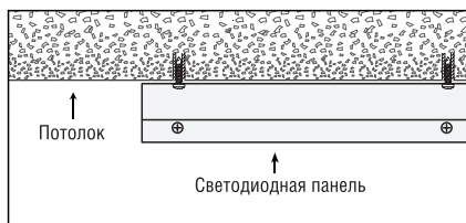
– Рисунок 3 – Настенно-потолочный монтаж (накладной)
